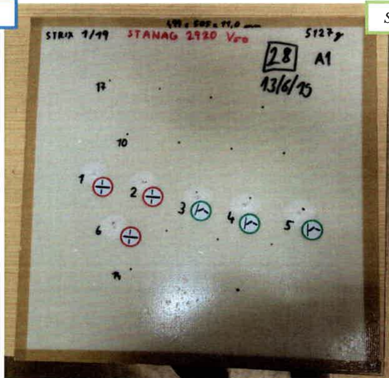
Vzorek po zkoušce – strana nástřelu Sample after testing – strike face
